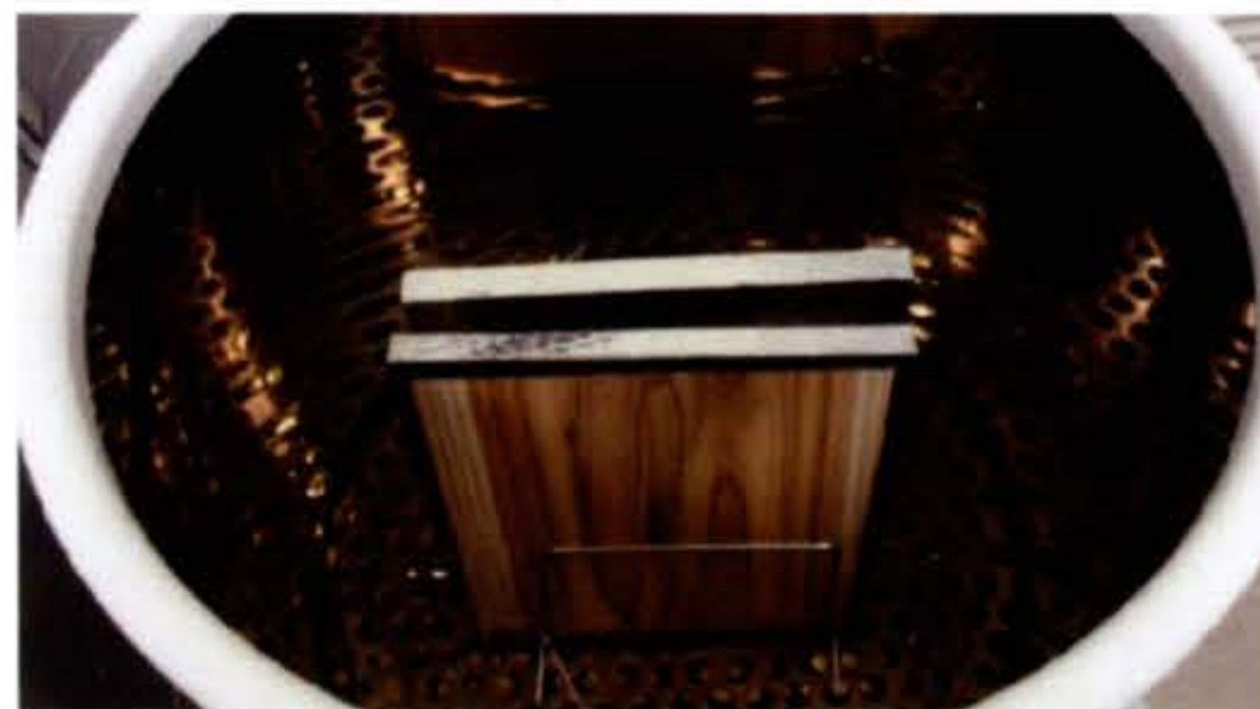
試験機関：(株)ダイヤ分析センター 試験方法：JIS A 1901 (小型チャンバー法)
